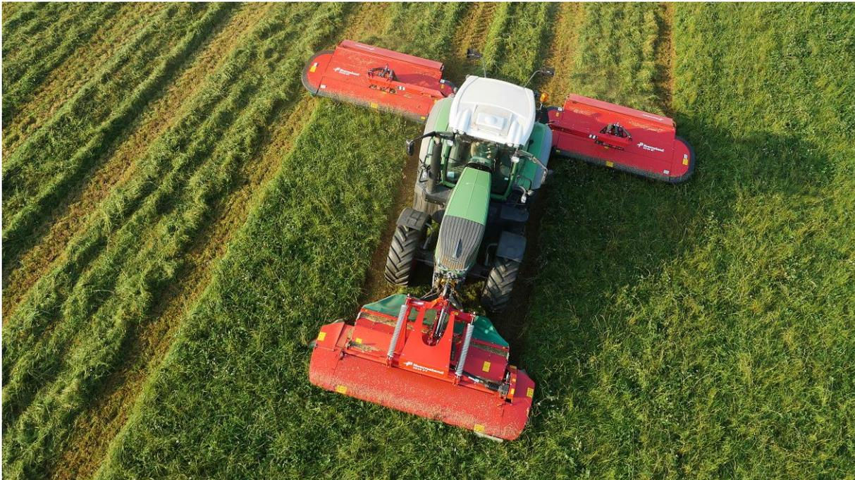
Система GEOMOW на косилке-бабочке 53100 обеспечивает максимальную эффективность работы данной комбинации: она постоянно отслеживает линию движения трактора и, соответственно, положение передней косилки, позволяя мгновенно подстраивать задние косилки для регулирования зоны перекрытия. Поэтому чистое скашивание возможно с первого раза при любых условиях и всегда при максимальной рабочей ширине 10,2 м.
