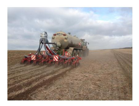
До сих пор, компания Квернеланд Груп предлагала жесткие рамы с шириной захвата 3, 4,5 и 6 м с возможной шириной рядка от 45 до 80 см или даже больше (только по требованию покупателя). Таким образом в зависимости от ширины захвата возможна определенная конфигурация из 4 - 12 рядков. С помощью Kverneland Kultistrip можно формировать и нечетное количество рядков.
