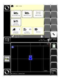
**Вспашка:** все важные регулировки осуществляются непосредственно из кабины трактора через ISOBUS терминал.
