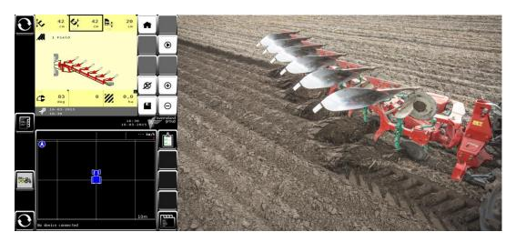
Компания Kverneland разработала навесной оборотный плуг ISOBUS Kv 2500 i-Plough, теперь устанавливать любые настройки для идеальной борозды можно непосредственно из кабины трактора. На ISOBUS мониторе, расположенном в кабине трактора, легко отрегулировать плуг касанием пальца.
